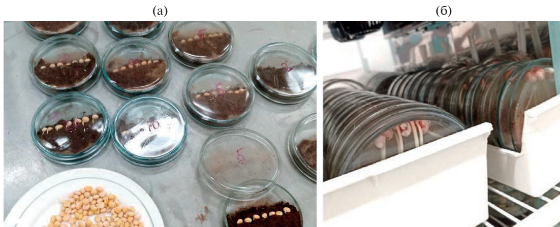
Рис. 1. Биотестирование тест-культуры люпина белого: (а) — предварительно пророщенные семена в чашках Петри с почвой, (б) — проростки люпина спустя 72 ч инкубирования в термостате при 20°C.
